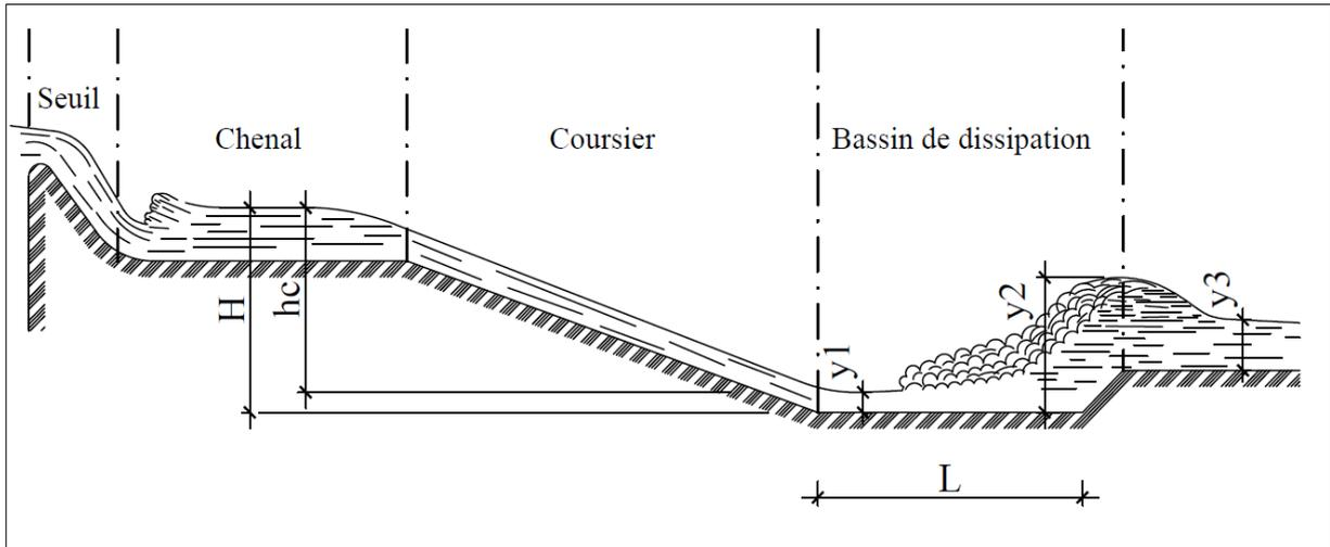
Figure 8 : Dimensions du bassin de dissipation
