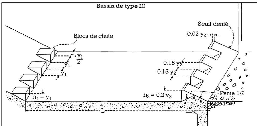
**Figure 7 : Schéma du bassin de dissipation « type 3 »**
